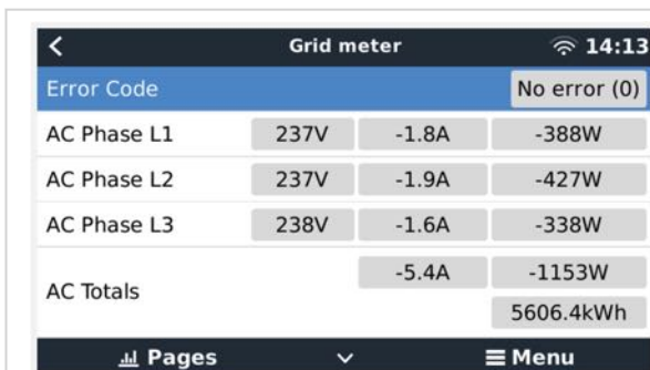
Detaillierte Übersichtsseite eines dreiphasigen Netzzählers
